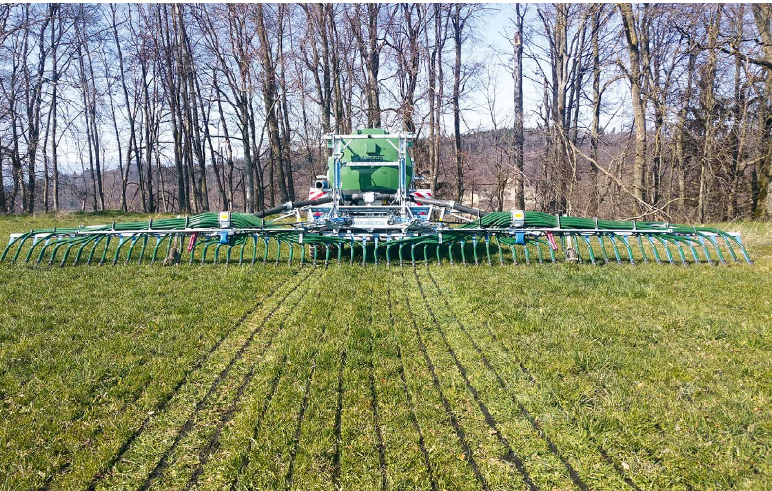
Abbildung 15: Ausbringung mit dem Schleppschuh. (Bild : Thomas Schnyder, Ökostrom Schweiz)
