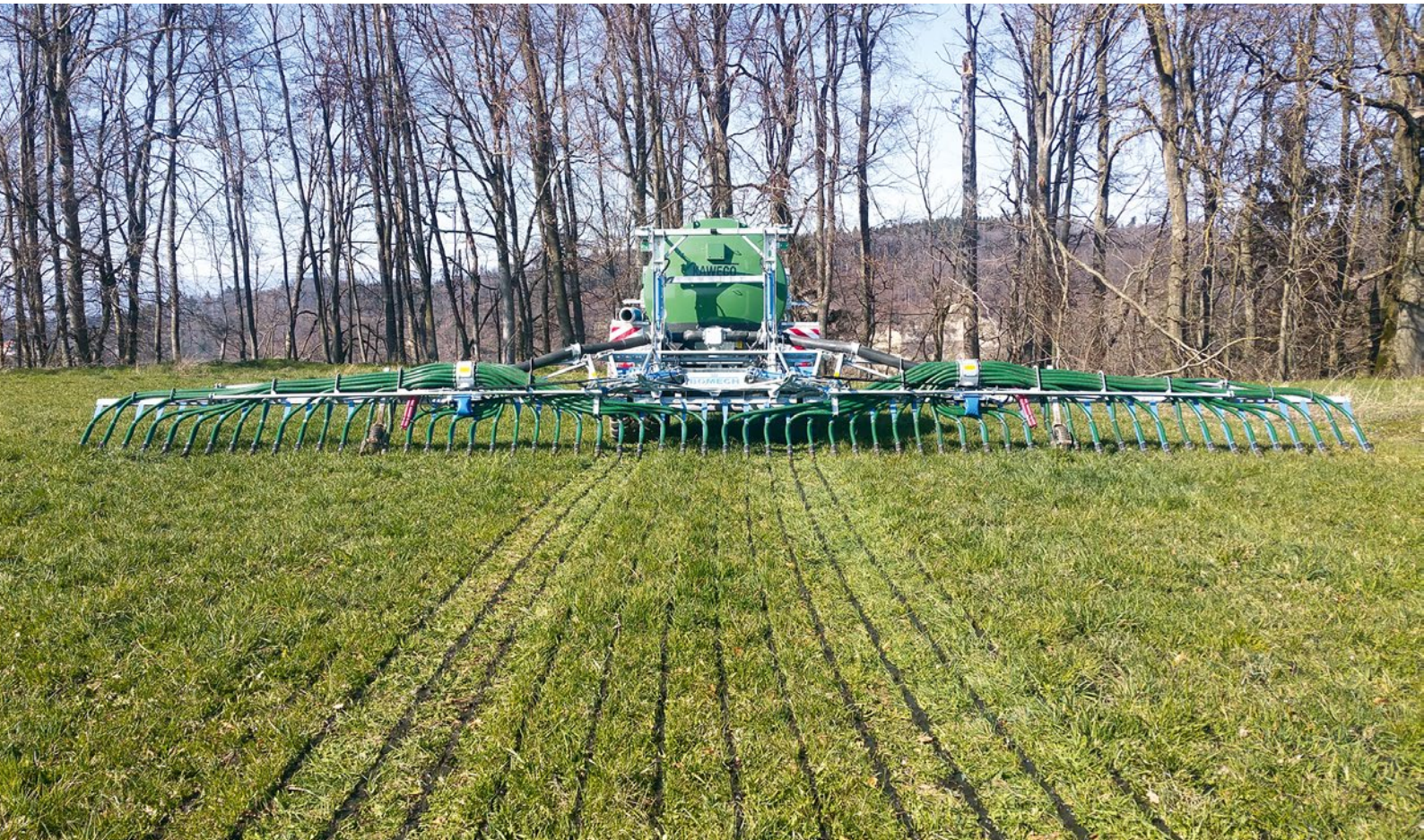
Figure 15: Epandage avec rampe à socs. (Photo : Thomas Schnyder, Ökostrom Schweiz)
