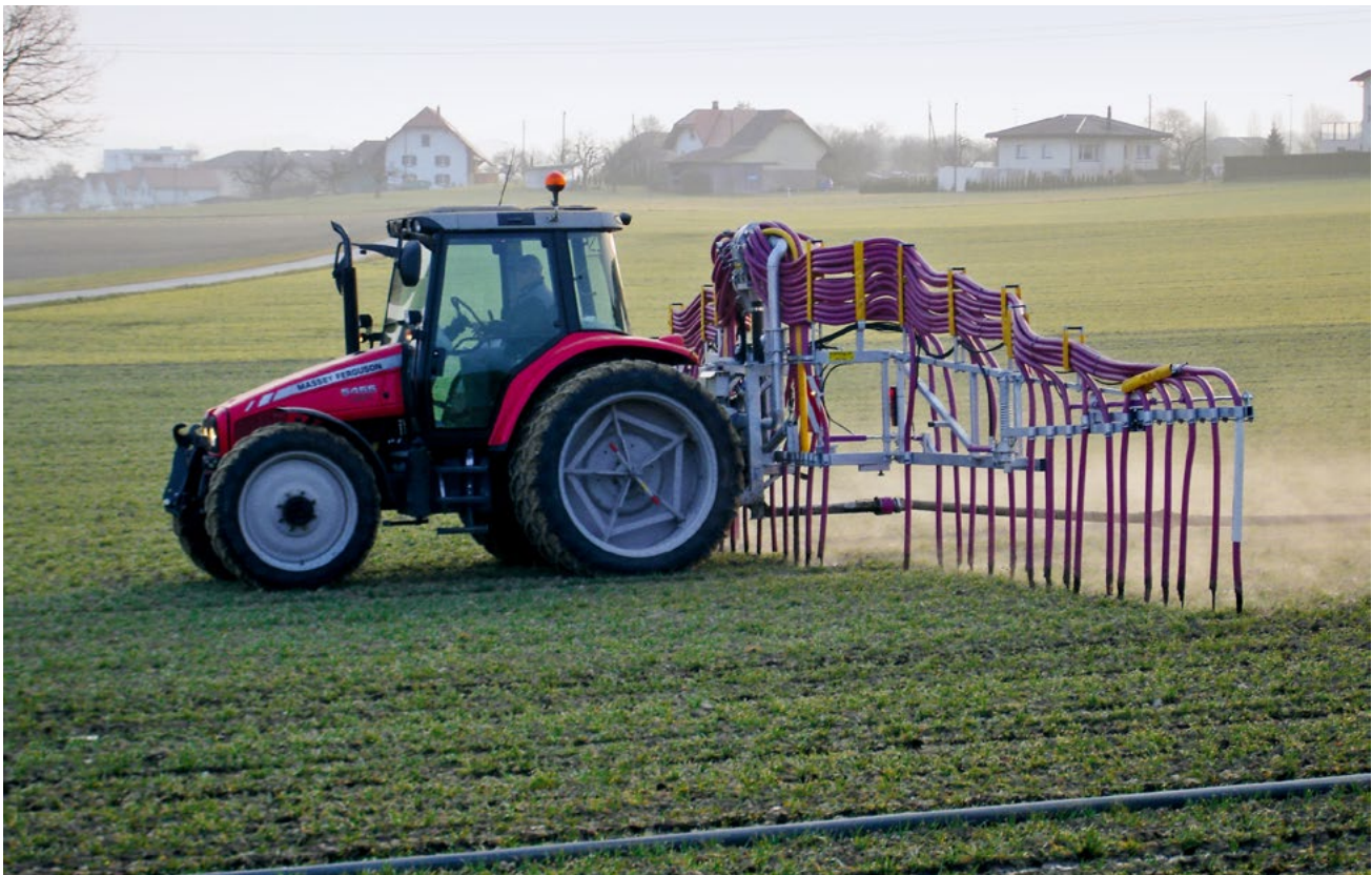
Figura 18: Tubi flessibili provenienti da un contenitore sotto pressione al bordo del campo: un sistema per contrastare il compattamento. (Foto: Thomas Schnyder)
